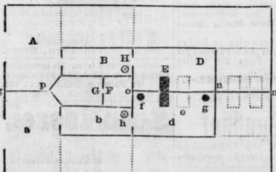
Die ganze Anlage ist durch die Mauern 9 p und 0 n in streng zu zwei Teilen, einen östlichen und einen westlichen, geteilt, und zwar dient der östliche zur Aufnahme der zu desinfizierenden Gegenstände, wie Kleidungsstücke, Wäsche, Betten, Wädel usw.
