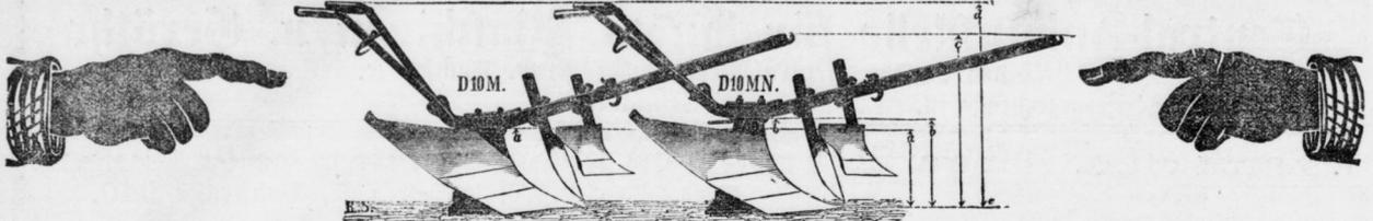
Pflug alter Construction mit Körper von Gußeisen. | Pflug neuer Construction mit erhöhtem Körper von Stahlguß.
