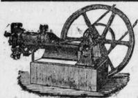
horizontale, geräuschlose Gastkraftmaschine, billige, bequeme und zuverlässigste Betriebskraft. Ueber 1200 Stück bereits in Betrieb. Auf der Fachausstellung in Chart 1878 durch Goldene Medaille ausgezeichnet. Keine besondere Wartung. Keine besondere Feuersicherung. Keine Verletzung durch ausstrahlende Wärme. Ueberzeugend getriebener Betrieb. Jederzeit ohne Vorbereitung betriebsfertig. Aufstellung in allen Etagen zulässig. Geringster Gasconsum.
