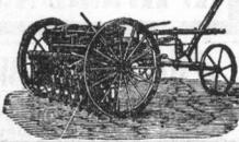
von 3 bis 12 Fuß Spurbreite, Stiefel- oder Schöpfkorn-System, allen Betriebsverhältnissen entsprechend, auf Verlangen auch mit selbstthätiger Regulierung, hydraulischer Bremse, welche auf comprimiertem Terrain eine wasserrechte Stellung des Sanftkorns, demzufolge sehr gleichmäßige Auslastung ermöglicht, ohne Rufpaus des Arbeiters, halten vorzüglich und empfehlen
