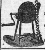
Schleif-Apparat für Mäh-Maschinen-Messer, welcher das sonst kostige und sehrtrüdelnde Schärfen der letzteren bequem u. rasch ermöglicht.
