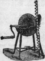
Schleif-Apparat für Mäh-Maschinen-Messer, welcher das sonst lästige und zeitraubende Schleifen der letzteren bequem u. rasch ermöglicht.
