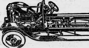
Das Opel Sechswagen-Chassis für Schnellwagen von 2 Tonnen Tragfähigkeit.
