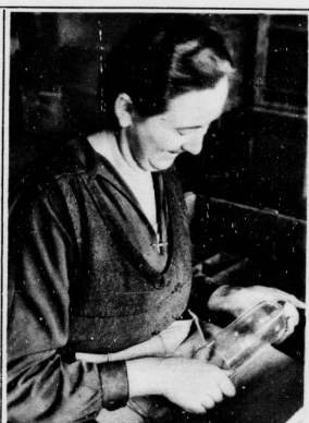
Zwischen äußere und innere Flasche werden Asbeststücke gelegt
