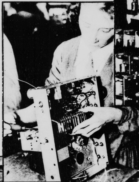
Verwirrend ist ein Blick in die Unterseite des modernen Superhet! Hunderte von Lötstellen und Kabelenden bezeichnen das Nervenzentrum des Empfangsvorgangs. Und dabei ist das „Chassis“, so wie Sie es hier sehen, noch lange nicht fertig. Es wird gerade die Widerstandsplatte eingesetzt
