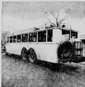
Omnibus mit Flüssiggas-Antrieb. Die Stahlflaschen (drei Stück) sind an der Rückwand des Wagens neben dem Reservewagen untergebracht.
