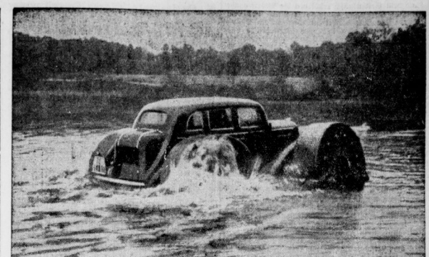
Das Auto, das durchs Wasser fährt. Das Problem eines Land- und Wasserausgangs hat schon manche, aber stets unzulängliche Lösun- gen gefunden. Vielleicht bewährt sich die Erfindung des Kölner Walter Bolensstein. Er montierte an ein normales Serienauto Pontonräder, die mit Schaufeln versehen sind. Dadurch wird eine leichte und sicher lenkbare Fortbewegung ermöglicht. Die ersten Versuche brachten eine Stundengeschwindigkeit von 20 km im Wasser. Zunächst sieht das Wasserrauto zwar noch sehr ungestaltig aus, doch der Erfinder hofft, bald eine ansprechende Form zu finden.
