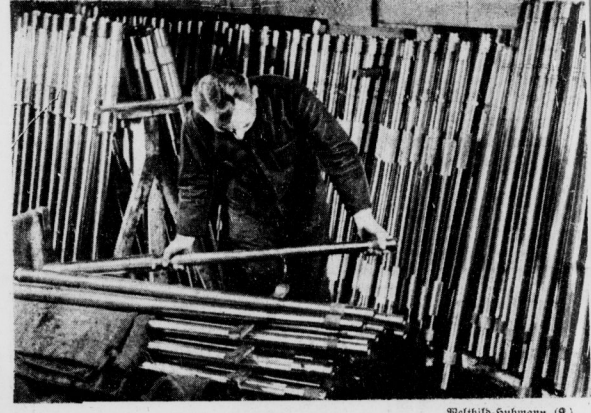
Ganz ähnlich wie die Maschinengewehrläufe entstehen auch die Läufe der leichten Flakgeschütze. Tag und Nacht sind zahllose Drehbänke in Betrieb. Unser Bild: In langen Reihen werden die Rohre gestapelt.
