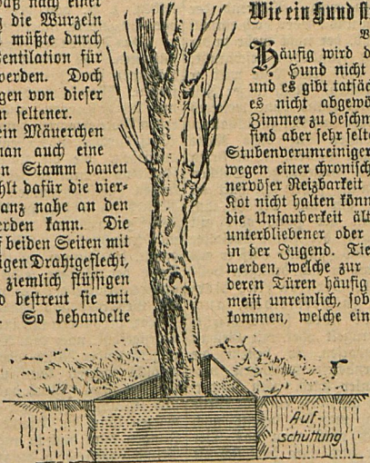
Abbild. 3. Man kann den Baumstamm auch schützen durch drei gußeiserne Platten, die man im Dreieck zusammenstellt.
