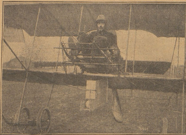
Eine mit einem Bombenlanzierrohr versehene Flugmaschine.
