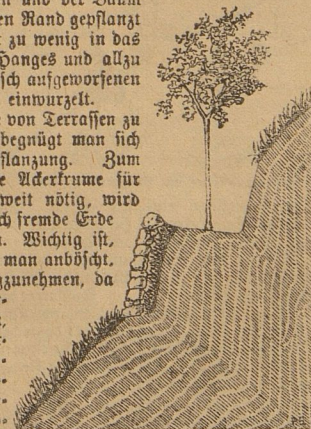
Abbildung 3. Trockenmauer zur Befestigung der Böschung.
