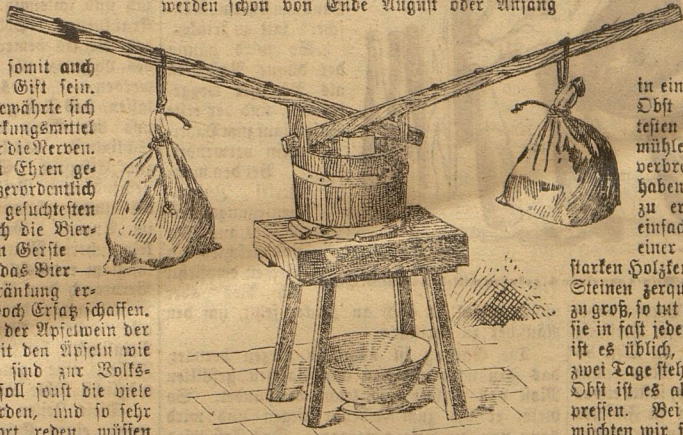
Abbildung 1. Einfache Obstpresse nach Hüllbrok-Putbus. In den Enden sind Steine, welche den Druck verhöhen durch Befestigung ausüben. Die Bebel ruhen an der Stelle ihrer Kreuzung auf einem Stützsteine, welcher auf den vordere befestigten Boden des Holzgefäßes und den unten offenen Schmelz in das untenstehende Gefäß.
