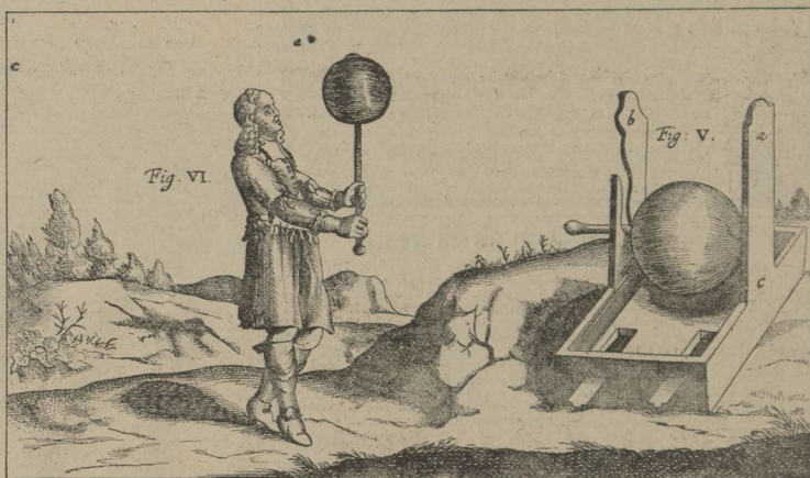
Otto von Guericke's Experimente mit elektrisierten Schwefelkugeln. Aus dem Werke „Weltall u. Menschheit“. Deutsches Verlagshaus Bong & Co., Berlin W. 57 u. Leipzig.
