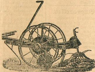
welche allen anderen Systemen vorgezogen wird. Die „Unerreicht“-Kartoffelerntemaschine arbeitet in einem Streifen von etwa 40 cm. Breite direkt neben der umgepflügten Furche, eine Beschädigung der Kartoffeln ist ausgeschlossen. Alles Kraut wird frei auf den Acker gelegt und kann leicht abgegrät werden.
