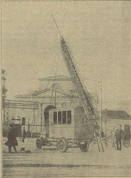
Automobil mit Leiter und Ausleger für drahtlose Telegraphie nach dem System Marconi. (Text I. S. 48.)
