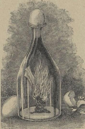
Zibibus kommt in die Flasche und nach einigen Sekunden setzt man das Ei einen Pfropfen auf die Flasche. Durch Verbrennung des Papiers wird die Luft in der Flasche erwärmt und nach der Abkühlung entsteht ein luftverdünnter Raum, in den der Druck der äußeren Luft das Ei hineintreibt. Die Dehnung des Eies während des Versuches sieht sehr komisch aus und gibt ohne Luftpumpe und physikalische Apparate den schlagenden Beweis von dem Druck der Atmosphäre.
