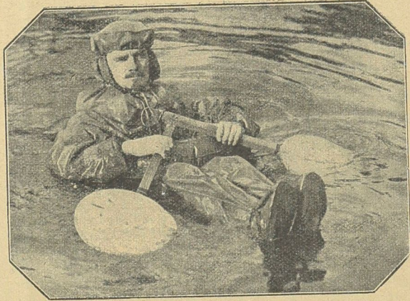
Schwimmprobe mit einem neuen Rettungsanzug, der große Tragfähigkeit besitzt und vor dem Erfrieren schützt.
