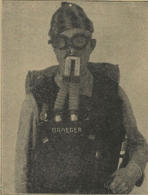
Ein neuer Rettungsapparat für die Besatzung von Unterseebooten.
