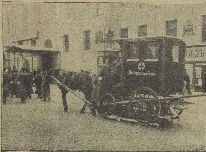
Ein russischer Sanitätswagen, der durch Aufsetzen auf Rufen in einen Schlitten umgewandelt ist.
