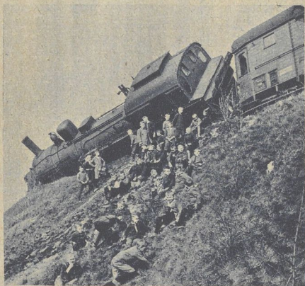
Auf dem Bahnhof Dobrilug-Kirchhain fuhr beim Rangieren ein Güterzug der Strecke Berlin—Dresden auf ein totes Gleis und riß den Frellbod um. Die Lokomotive wühlte sich tief in die Erde ein und lag hart am Rande der 3 m hohen Böschung. Phot. H. Kugler, Kirchhain
