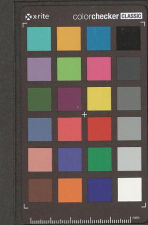
Das ist das, was unter dem Namen 'colorchecker' bekannt ist. Es ist ein Werkzeug, das in der Fotografie und in der Druckerei verwendet wird, um die Farbwiedergabe zu überprüfen und zu korrigieren. Die farbigen Quadrate sind in einer 4x8-Matrix angeordnet. Die Beschriftung 'x-rite colorchecker CLASSIC' ist oben links zu sehen. Unten rechts befindet sich eine Maßskala in Millimetern.
