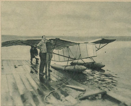
Ein neues Segel-Wasserflugzeug ohne Motor, mit dem der durch seine Landsegelflüge bekannte Hans Richter vorläufig auf dem Templiner See bei Potsdam Versuche macht Voigt, Baumshulenberg
