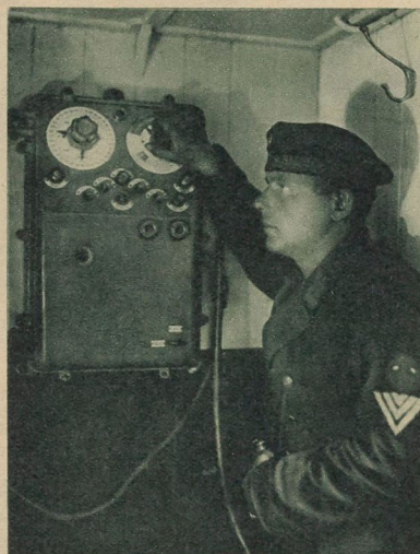
Das Gehirn des Fernlenkschiffes: Der Mann am Sendeparat in der Kommandostelle des Juntschiffes „Blitz“ Photothet
