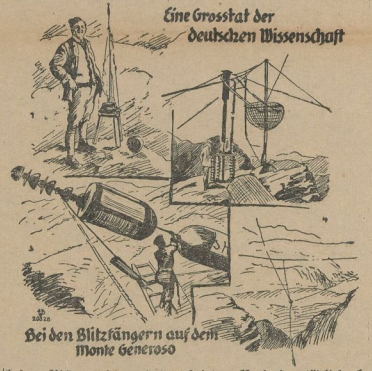
Unsere Bilder zeigen: 1. den bei den Versuchen tödlich abgestützten Techniker Urban auf dem Dach des Kalm-Hotels bei einer Messung; 2. die Montage der riesigen Isolatorentoren und Sprühkugelförper; 3. einen Teil der Versuchsanlagen auf einer Felsenrippe; 4. die großen Durchgangseleitungen zum Aufliegen der Blitze (im Hintergrund die Bucht von Lugano).
