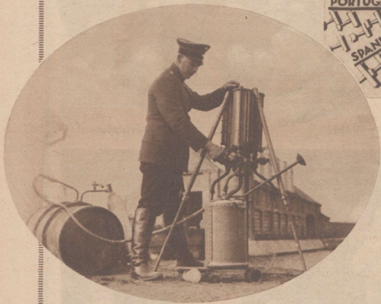
Füllen eines Nebelgerätes zum Verschleiern des Werkes im Hintergrund
