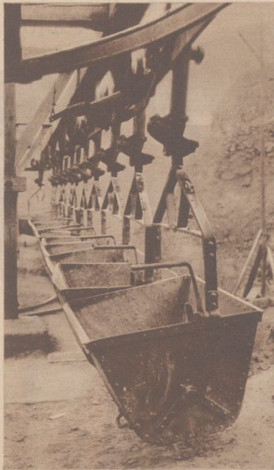
Kipploren der Sängebahn zum Abtransport des geförderten Kalkes — eine Kette ohne Ende
