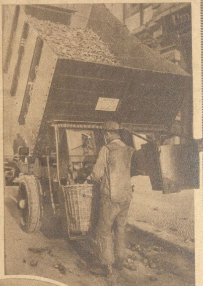
Eine neue Abfüllvorrichtung für Kots (Schlem Dreer), die den Kotstransport vom anfahrenen Fuhrwerk zum Hauskeller bedeutend erleichtert. Wesentlich ist, daß die gefüllte Kiste mechanisch auf die erforderliche Schulterhöhe gehoben werden kann. Kopfste
