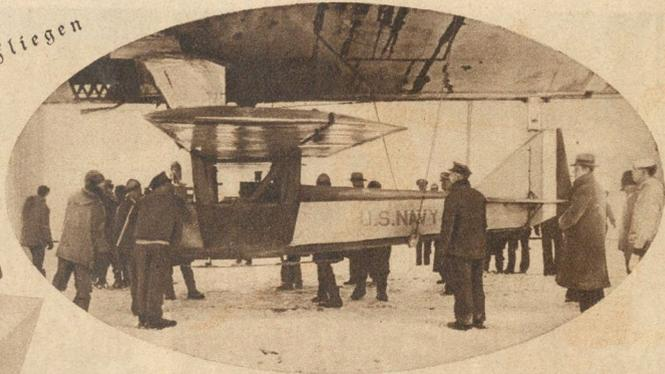
Ein Flugzeug startet vom Luftschiff. Diese neuartigen Versuche wurden mit der „Los Angeles“ und einem in Kassel gebauten deutschen Gleitflugzeug ohne Motor ausgeführt. Das Flugzeug war an der unteren Seite des Schiffes angebracht, wurde in etwa 1000 Meter Höhe gelöst und von dem amerikanischen Flieger Barnaby sicher im Gleitflug zur Erde geführt.
