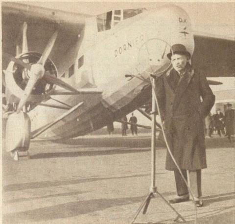
← Dr. Dornier führt seine neueste Flugmaschine vor: „Do K“. Der mit vier Motoren zu je 240 PS ausgerüstete Metall-Hochdecker hat eine bequem ausgestattete Kabine für zehn Personen
