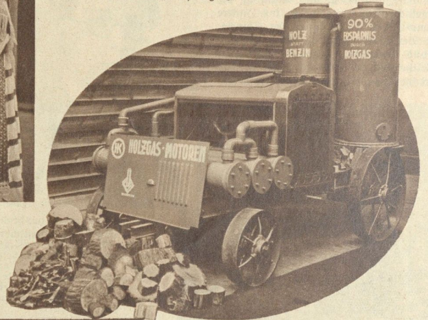
Ein Wolgas-Motor, der deutsches Holz als Brennstoff verwendet und den Verbraucher dadurch von dem in seinen Holzprodukten erst einzuführenden Benzin freimacht. Presso-Photo
