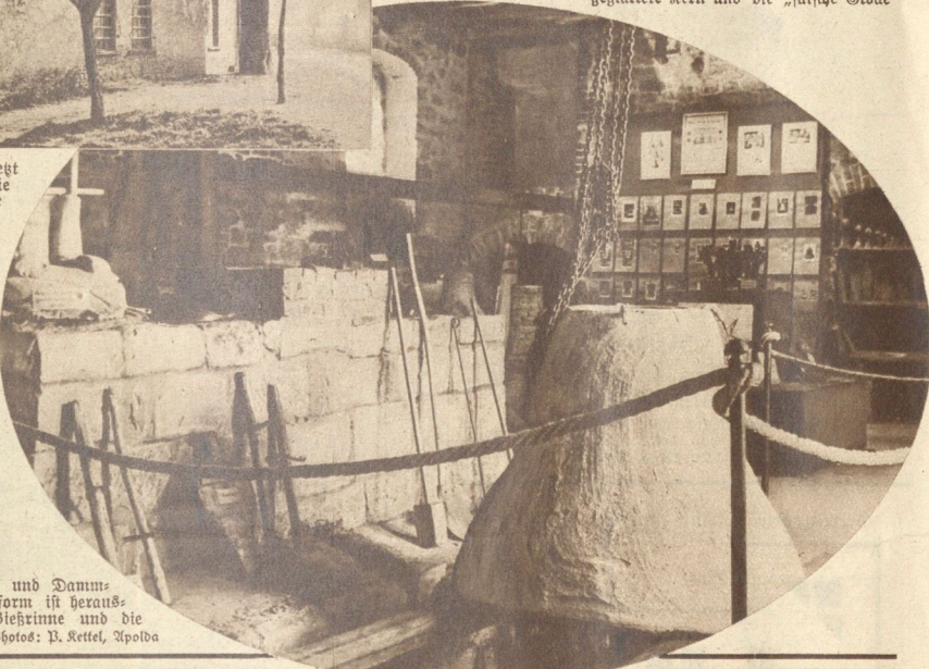
Die Vorstufen der Glocke: Der roh gemauerte und der geglättete Kern und die „falsche Glocke“
