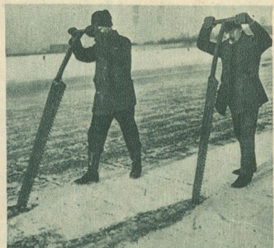
Erwerbszweige, die nur der Winter bringt, sind die Schilfmacht und die Natureisgewinnung. Das Zerfägen des Eises, bei dem mit großen Handsägen gearbeitet wird, erfordert besondere Ausfrennung und ist noch schwerer als die mühselige Arbeit der Schilfernte Photos Sennede
