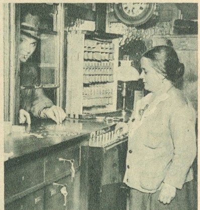
Eine Vereinigung von Bahnsteigsperre und Fahrkartenschalter wurde bei der Untergrundbahn der Reichshauptstadt in Betrieb genommen; der Fahrgast hat an der Sperre die Gebühr zu zahlen und empfängt daraufhin die bereits gelöste Karte, die ein Sammelbehälter auf einen Gebedruck der Beamtin hin auswirft Pres-Photo
