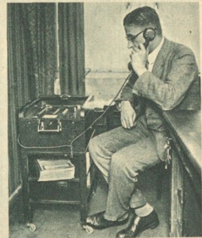
Eine sinnreiche Fernsprech- und Signal-Anlage , die es z. B. einem Fabrikleiter ermöglicht, sich unmittelbar mit allen Stellen seines Betriebes zu verbinden, durch Lautsprecher-Anordnungen zu geben und vieles andere mehr. Phot. Atlantic
