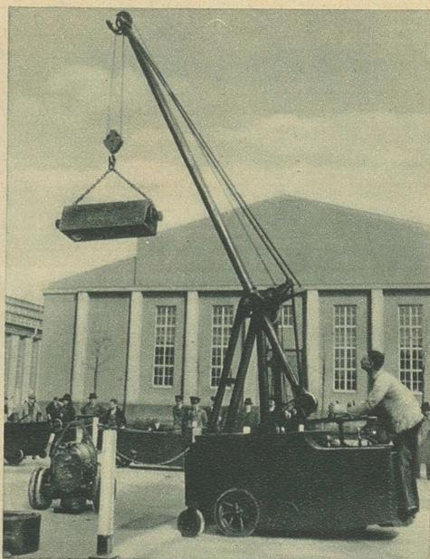
Schienerlofer Akkumulatorentram, der die Wagen selbst an Ort und Stelle zieht und Lasten von über 20 Zentner hebt
