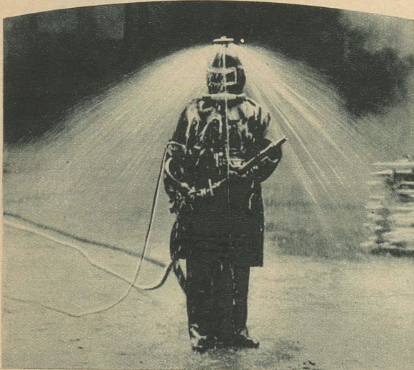
Der Mann mit der „kalten Dusche“, — eine ausgezeichnete Ausrüstung, die die Feuerwehrleute vollkommen gegen das Flammenmeer schützt. Dieser Verlebensapparat wurde kürzlich mit anderen neuen Rettungsgeräten bei der Berliner Feuerwehr vorgeführt. Phot. Wide World
