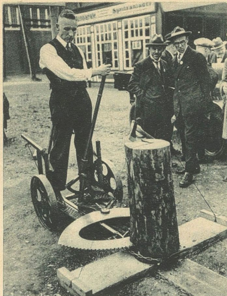
Von der Technischen Messe: Eine Baumfällmaschine, die es einem einzelnen Manne möglich macht, die stärksten Bäume dicht über dem Erdboden abzufällen Photo-Union
