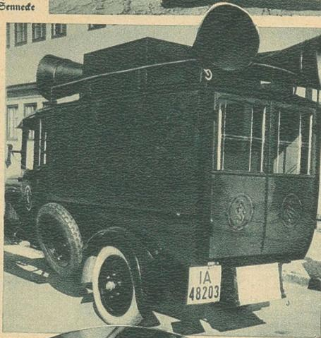
Radio an Bord. Bild in die auf der Funkausstellung eingerichtete Schiffskabine mit Sendestation. — Bekanntlich hat man unter anderem auch kürzlich ärztliche Rat schläge mittels Radio von Schiff zu Schiff auf hoher See weitergegeben. Phot. Sennede. Bild Mitte rechts: Für allgemeine Werklametzwecke wurde ein Automobil gebaut, das mit vier Lautsprechern ausgerüstet ist. Der Wagen verbreitet auf seiner Fahrt durch die Straßen beliebige Nachrichten, Musik u. a. Dr. Pr. Ph. 2.
