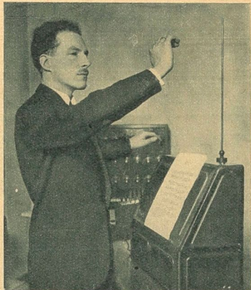
Ein mit besonderen Schaltern und Antennen ausgerüsteter Apparat des russischen Professors Tcheremin vom physikalisch-technischen Institut in Leningrad. Dieser soll durch bloßes Spiel der Hände in der Luft Tonabstimmungen von außergewöhnlicher Feinheit und Ausdrucksform wiedergeben Sennede
