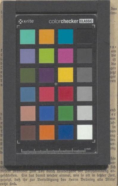
Das Bild zeigt eine Farbkorrekturtafel (ColorChecker Classic) mit einer Maßstablinie in Zentimetern und Millimetern. Die Tafel enthält verschiedene Farbpunkte und Graustufen zur Farbkorrektur in der Fotografie.
