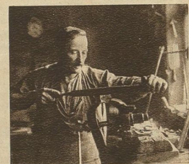
Der Kern wird aus einem Stück geschruppt
