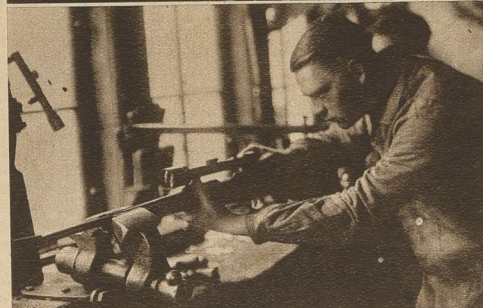
Links: Aufmontieren eines Fernrohres auf den Gewehrlauf
