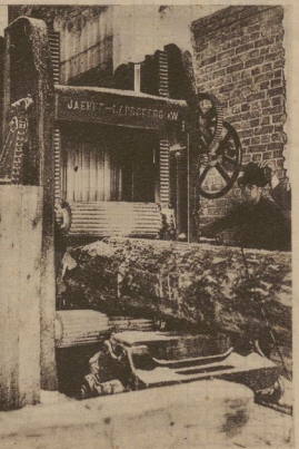
Unten: Riffelwalzen, die die Stämme gegen die Gattersägen drücken
