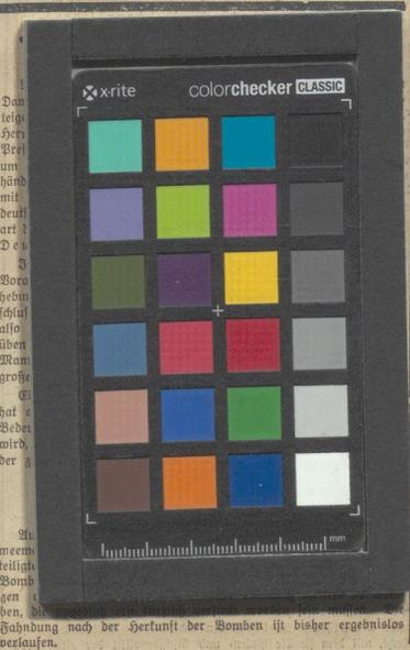
Das Bild zeigt eine Farbkalibrierungstabelle (ColorChecker) mit verschiedenen Farbtönen und Graustufen, die zur Kalibrierung von Druckern und Kameras verwendet werden.
