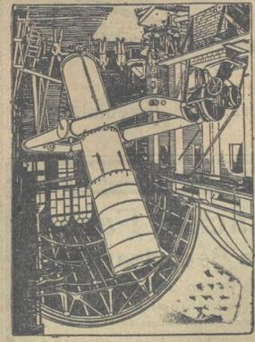
Ein Zehlfach-Doppelfernrohr mit zwei Objektiven von 600 mm Stielen Durchmesser wurde in der Sternwarte Rembang auf Java aufgestellt. Die Objektive sind in einem zylindrischen Rohr von 17 m Durchmesser eingebaut. Das eine Objektiv dient für optische Beobachtungen, das andere für atmosphärische Aufnahmen. Das Gesamtgewicht der beweglichen Teile des Instruments beträgt 14000 Kilogramm.
