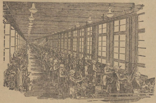
Einer der riesigen Fabrikhallen; die Maschinen stehen eng, um das Werkstück besser zu transportieren. Gute Beleuchtung und gute Resonanz
