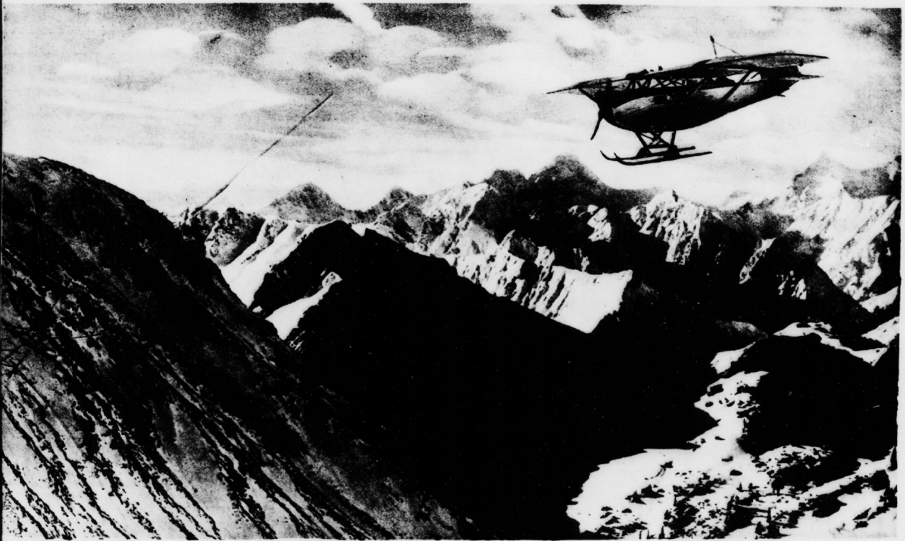
Ein Flugzeug für verschneites Gelände haben die Sablotnik-Werke neuerdings in den Verkehr gebracht; der Apparat ist mit riesigen Schneeschuhen versehen; selbst bei stärkster Schneedecke im Gebirge gestattet er ein gutes Starten
