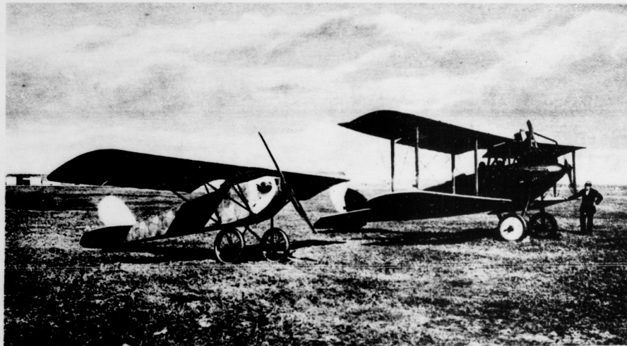
Der kleinste und leichteste Flugapparat für Sportzwecke. Es ist ein Eindecker von 7 Meter Spannweite und 5 Meter Länge; sein Gewicht beträgt 180 Kilogramm, die motorische Kraft (28 PS.) entwickeln 2 luftgetriebene Horizontalzylinder; es kann eine Stundengeschwindigkeit von 110 Kilometer erzielt werden
